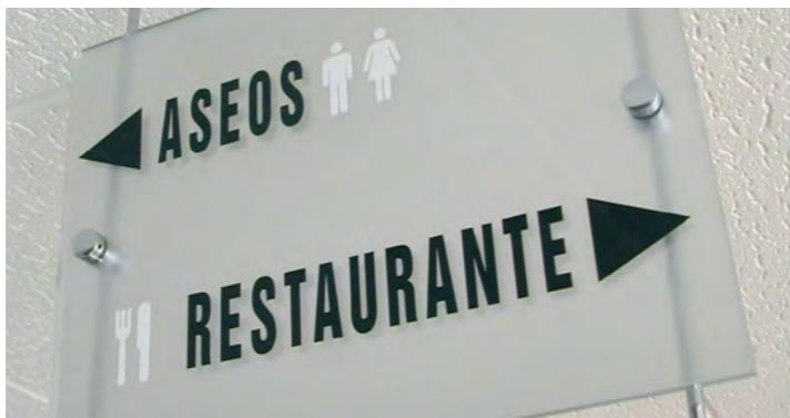
Este material proviene de la polimerización del metacrilato de metilo. Tiene una gran cantidad de aplicaciones, es muy frecuente encontrar elementos de señalética de identificación de espacios realizados en este material.
