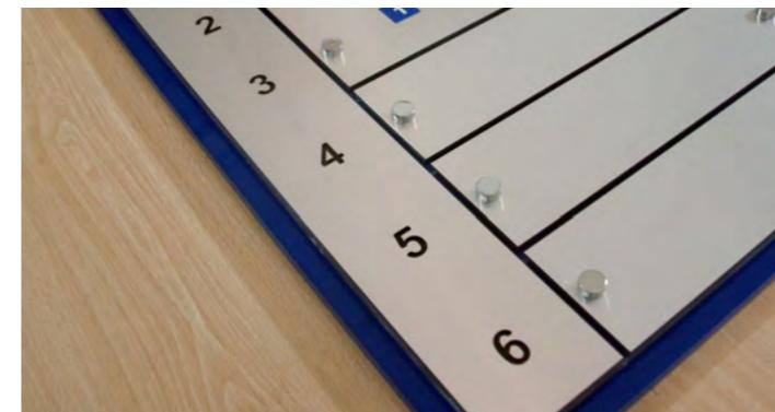
Dibond® o Alucobond® son materiales compuestos conformados por dos de los materiales anteriormente analizados. Cuenta con un núcleo de polietileno cerrado por dos capas de 0,3mm de espesor de aluminio.
