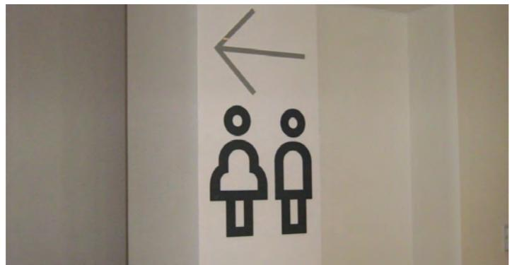
Se corresponden con soportes de texto o imágenes impresas o serigrafiadas sobre una lámina de vinilo en cuya parte posterior se ha dispuesto una capa de adhesivo. Estas lámina va adherida a un transfer hasta que se sitúa en su ubicación final.
