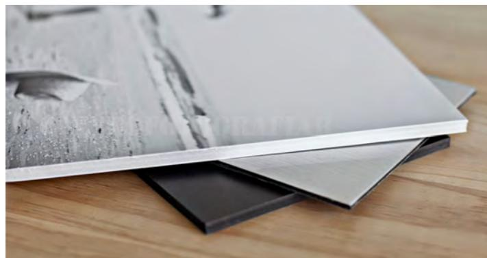
La aplicación del PVC para elementos de señalética se efectúa principalmente a través de un material compuesto denominado comercialmente Forex®, que consta de un núcleo de PVC cerrado por dos láminas laterales sobre las que se puede imprimir.
