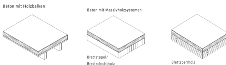
fig. 39. Distintos tipos de forjado híbrido (Revista proholz, zuschnitt 54, 2014)
