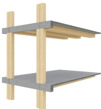
Fig. 60 División entre pisos debido al uso del hormigón (Kaufmann, 2012).
