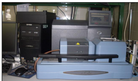
- . Figura 34: Termobalanza “SDT Q600 de TA Instruments”. -
