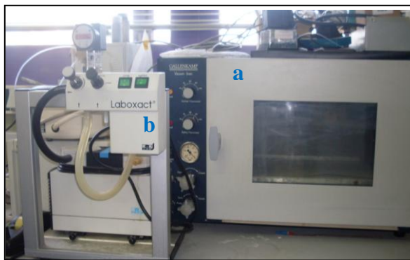
- Figura 13: Secado de las cenizas carbonatadas. Estufa (a) y bomba de vacío (b).-
