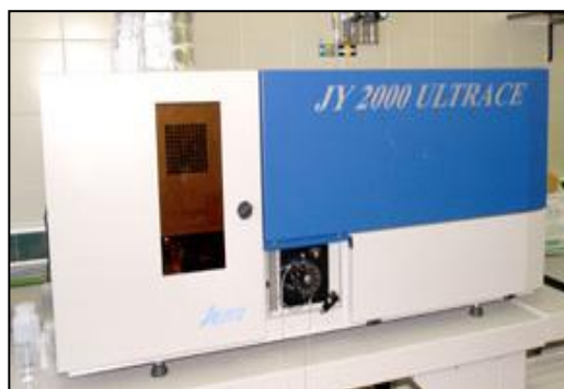
-. Figura 31: Espectrómetro de emisión atómica ICP “Jobin Yvon 2000”.-
