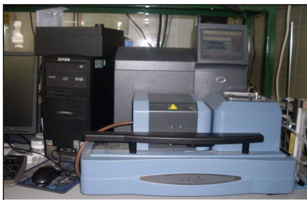
- Figura 14: Análisis de las cenizas carbonatadas secas, TGA.-
