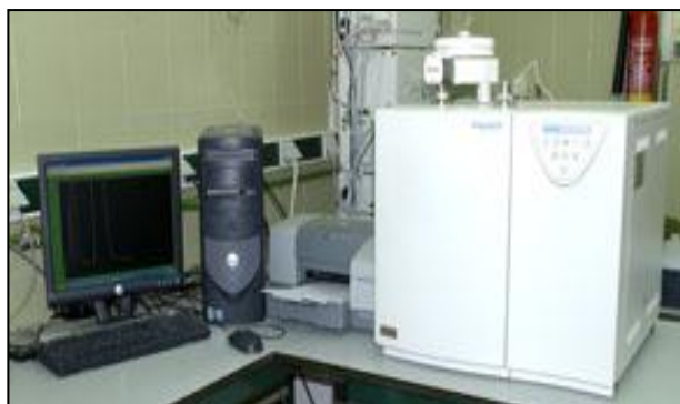
-. Figura 29: Analizador “Carlo Erba 1108” y analizador “Termo Flash 1112”.-
