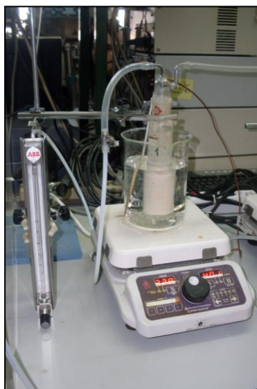
- Figura 12: Carbonatación de las cenizas.-
