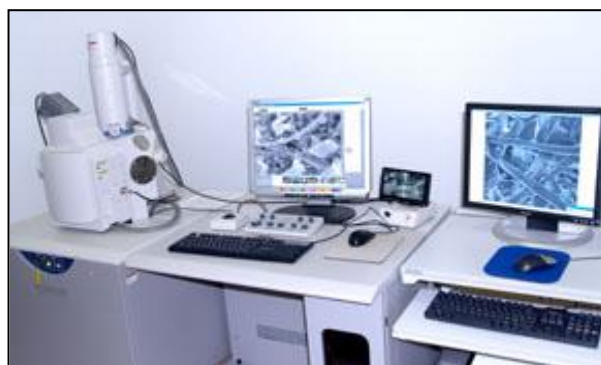
- Figura 32: Microscopio SEM “Hitachi S-3400 N” y EDX “Röntec XFlash”.-
