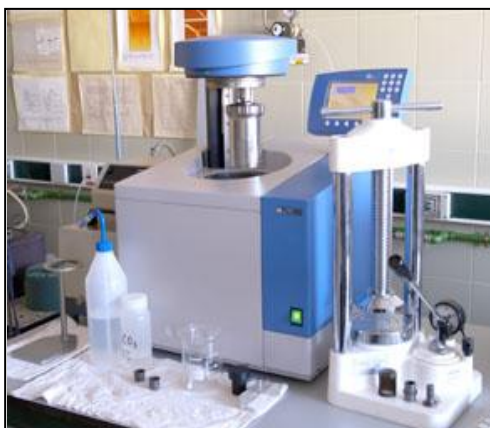
-. Figura 30: Calorímetro isoperibólico “IKA C-2000”.-
