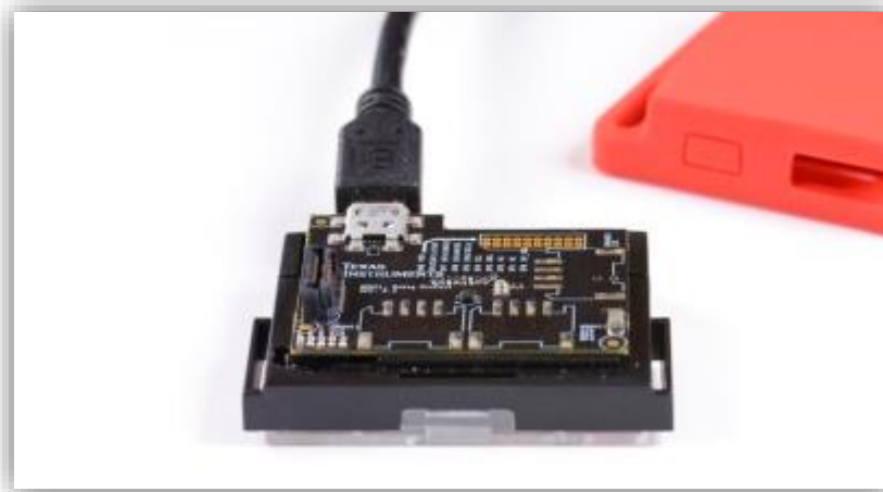
Kit de depuración para Sensortag CC2650, Obtenida en la web de Texas Instrument
