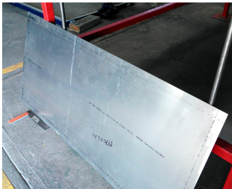
Figura 12. Material de placa colectora – acero inoxidable (Fuente: Elaboración propia)
