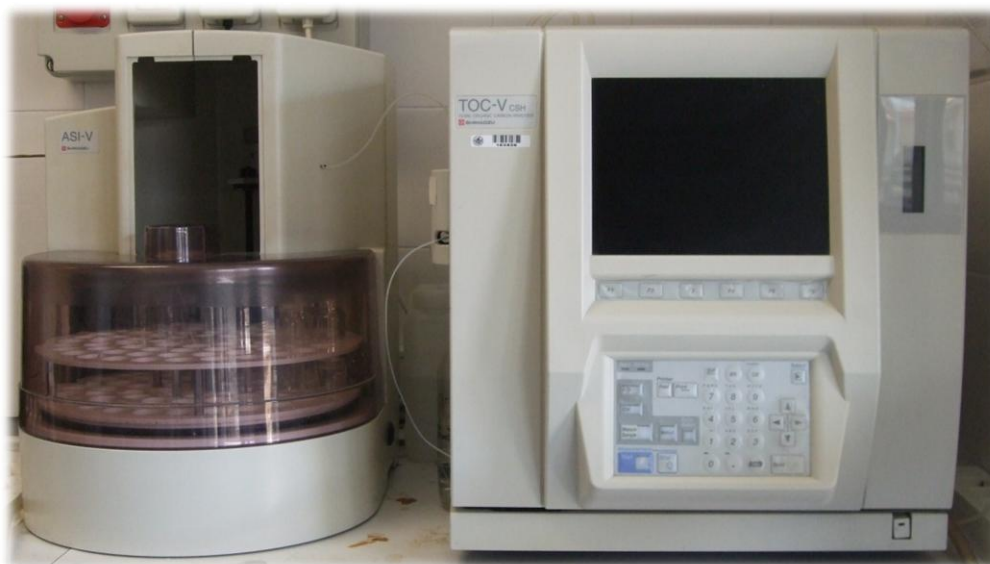
Figura III.1. Analizador de Carbono Orgánico Total SHIMADZU, modelo TOC-V CSH
