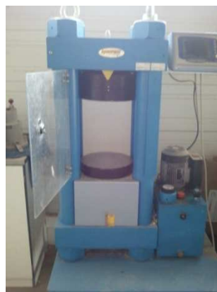
Figura 5.18 "Máquina de ensayo a compresión"
