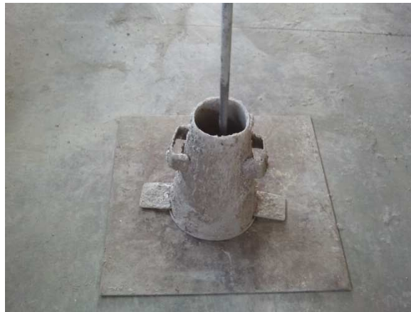
Figura 5.11 “Cono de Abrams utilizado en el ensayo de consistencia”
