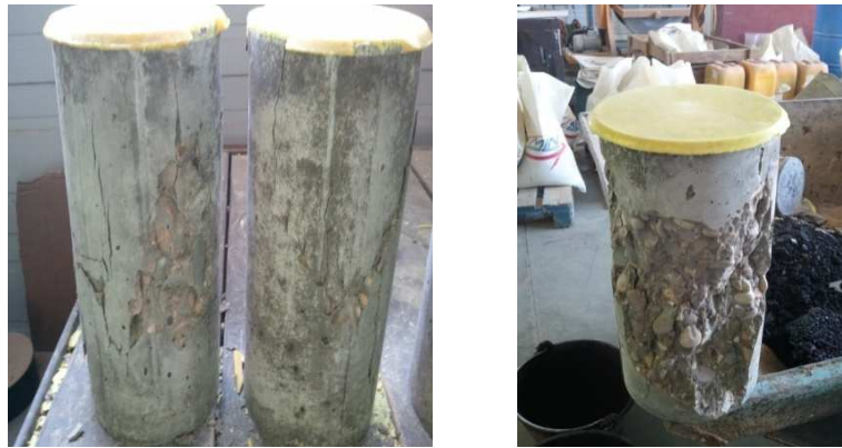
Figura 5.9 “ Probeta rota después del ensayo ”
