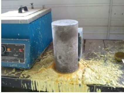
Figura 5.6 "Proceso de refrentado"
