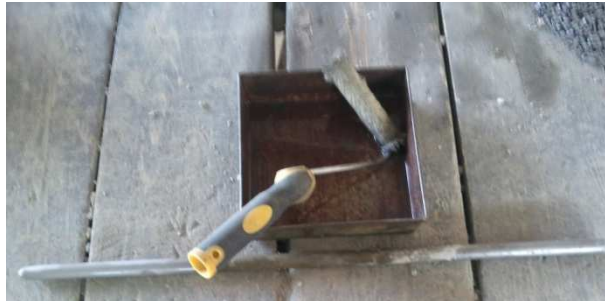
Figura 5.13 “Recipiente y rodillo para aplicar líquido desmoldante”
