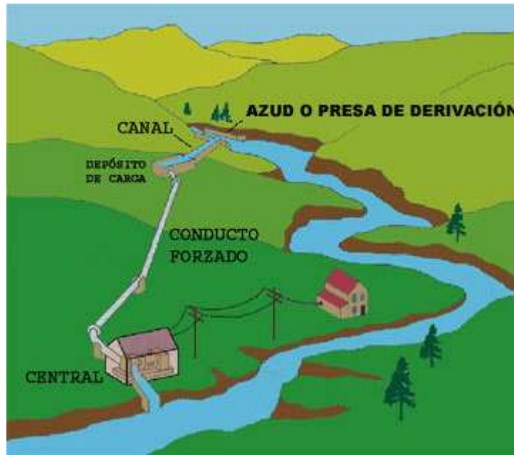
Ilustración 1: Esquema de una central de agua fluyente.
