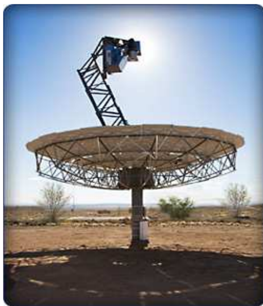
Figura 14. Dispositivo disco Stirling SunCatcher producido por SES.
