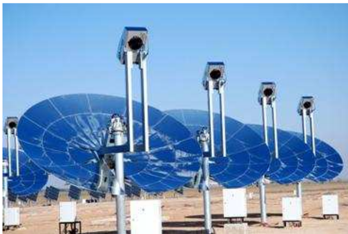
Figura 15. Dispositivo disco Stirling producido por Renovalia Energy.
