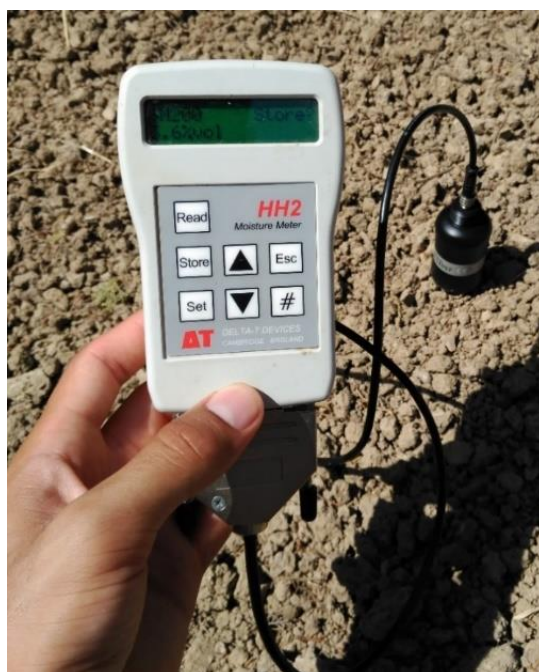
Figura 24. Realizando una medida de humedad en campo con la sonda capacitiva (Fuente: Elaboración propia).
