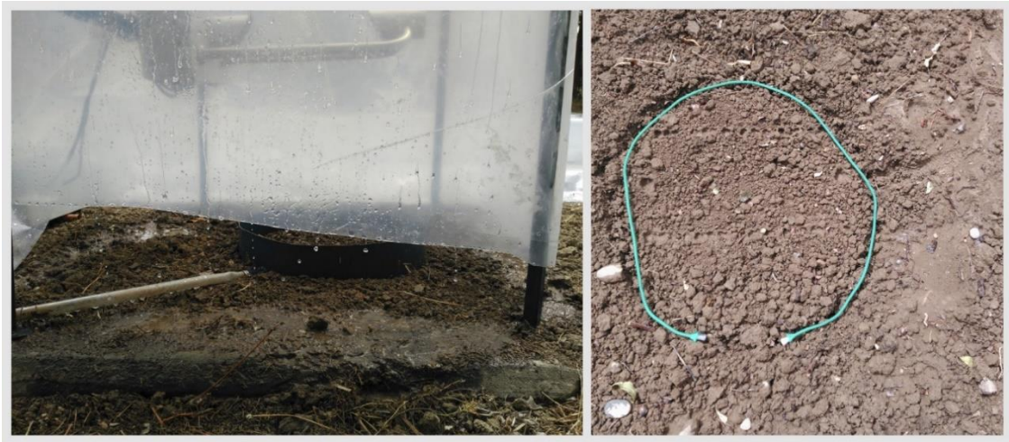
Figura 34. Vista de los encharcamientos en el suelo debido al flujo de agua canalizado a través del plástico (izquierda), y vista del suelo minutos después de la simulación de lluvia (derecha), donde se observa una desagregación del suelo mayor en la zona exterior al cilindro de medición (Fuente: Elaboración propia).
