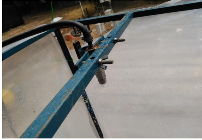
Figura 28. Vista de la boquilla en funcionamiento, instalada en la parte superior de la estructura del simulador (Fuente: Elaboración propia).
