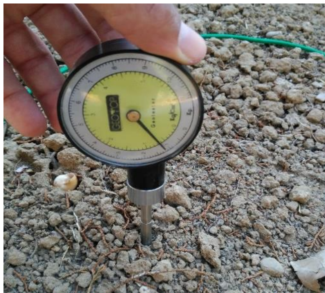
Figura 23. Realizando una medida de resistencia a la penetración en campo (Fuente: Elaboración propia).
