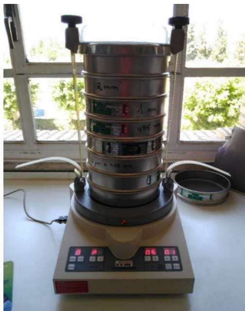
Figura 25. Detalle de la tamizadora electromagnética (Fuente: Elaboración propia).
