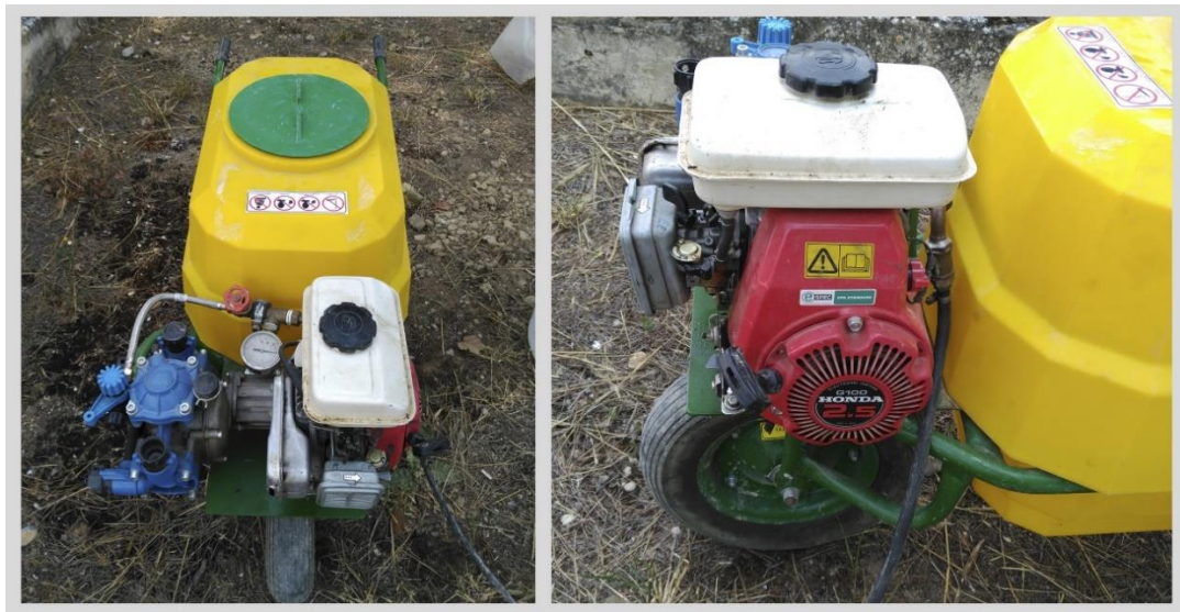
Figura 30. Vista del carrito manual que contiene el sistema de bombeo y el depósito del simulador (Fuente: Elaboración propia).
