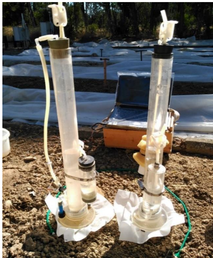
Figura 35. Infiltrómetros de disco utilizados en el experimento (Fuente: Elaboración propia).
