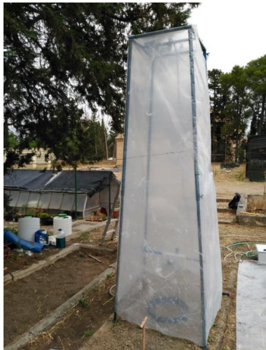
Figura 29. Vista de la estructura del simulador con el plástico protector del viento (Fuente: Elaboración propia).
