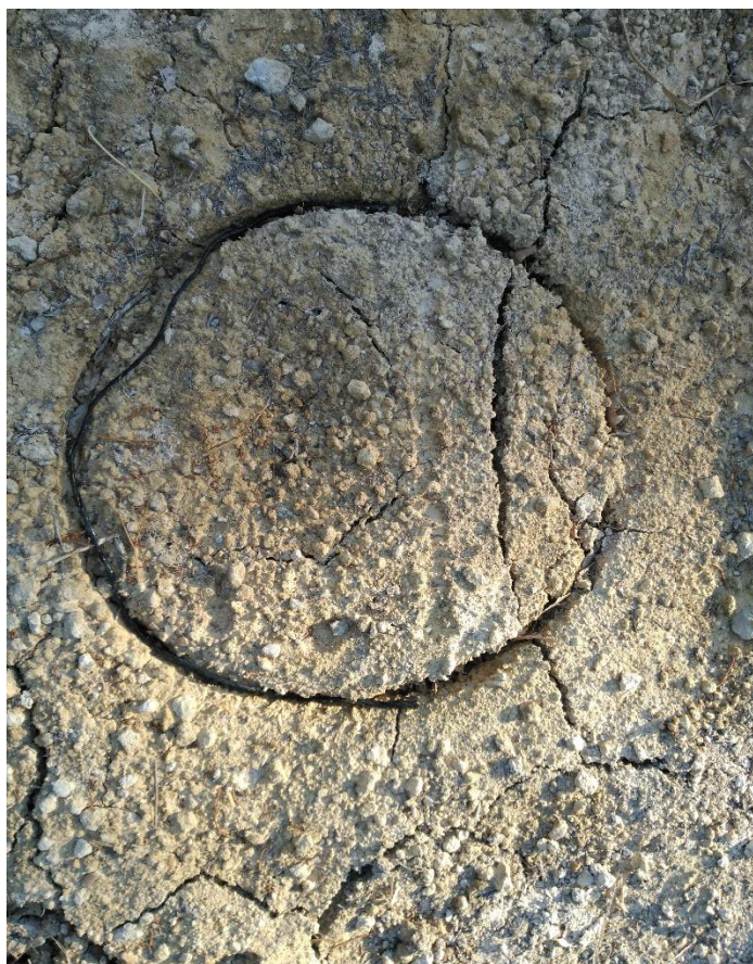
Figura 51. Se muestra la costra formada en el Gypsisol para el evento de lluvia más intenso (Fuente: Elaboración propia).
