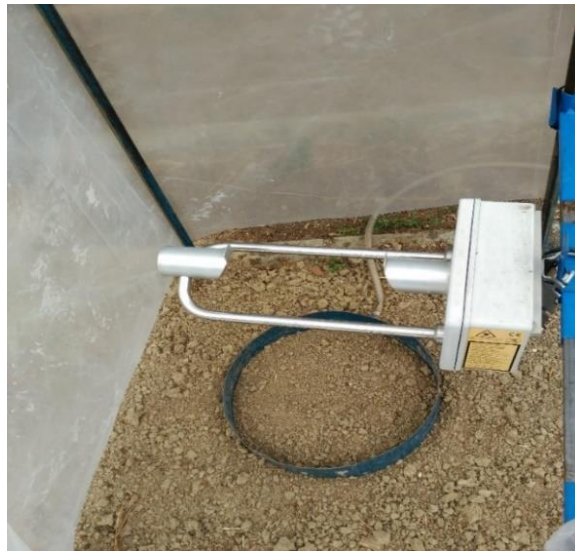
Figura 32. THIES instalado en la estructura del simulador de lluvia (Fuente: Elaboración propia).
