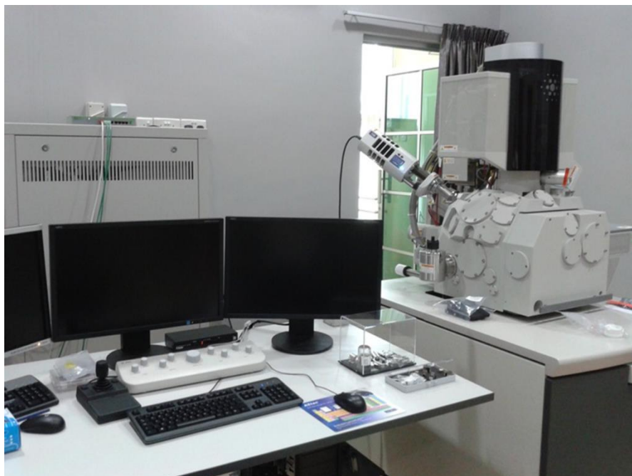
Figura 3. 6 Imagen de microscopio electrónico de barrido FEI VERIOS 460.
