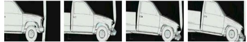
Estudio de impacto sobre seguridad pasiva en estructura a 50 km/h en farola metálica
