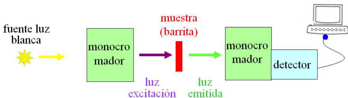
Figura 29 , Esquema de la instalación experimental para estudiar la luminiscencia del material.
