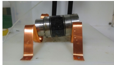
Fig. 5.3 Cámara de tratamiento con endrinas conectado a los electrodos
