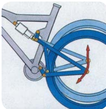
Esquema del funcionamiento del pivote virtual.
