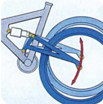
Esquema del funcionamiento del monopivote.
