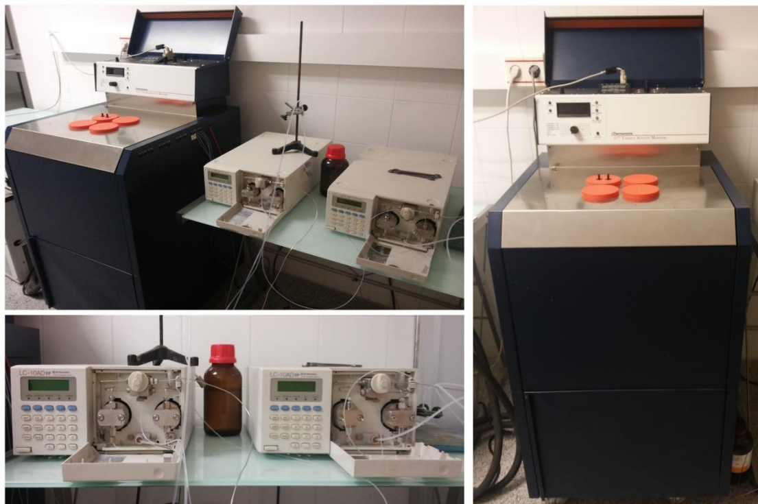
Figura 2. Equipo utilizado para la medida de las entalpías de exceso. A la derecha, el monitor de actividad termal 2277 TAM. Abajo a la izquierda, las dos bombas de cromatografía Shimadzu LC-10ADVP HPLC. Arriba a la izquierda, el sistema conjunto.
