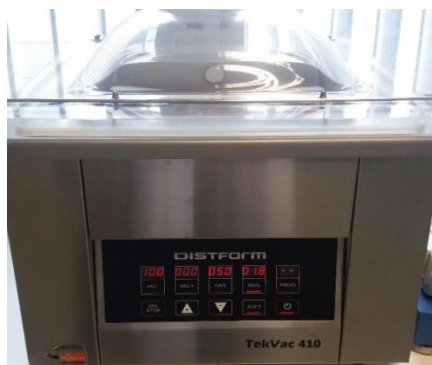
Figura 2. Máquina de vacío TekVac 410 utilizada para conseguir la atmósfera protectora.
