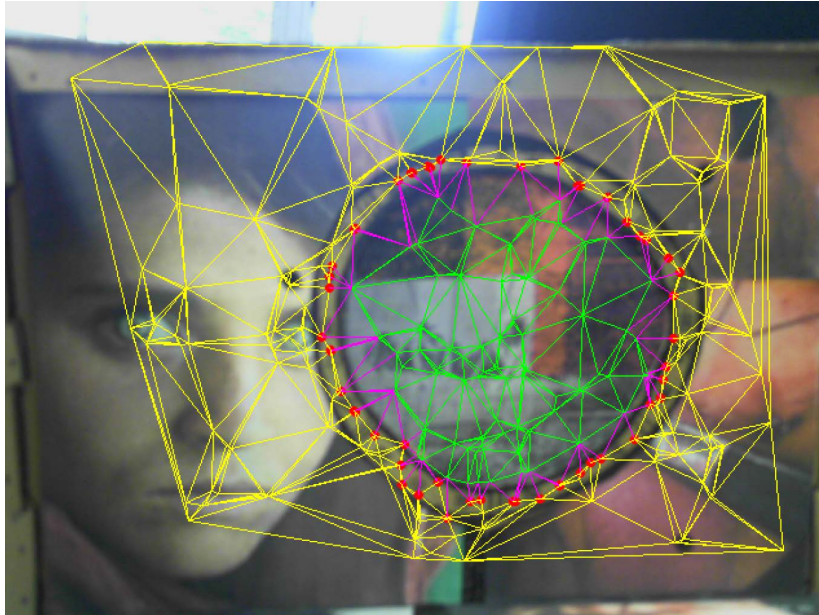
Figura 2.4: Triangulación de Delaunay usando los puntos del fotograma. Verde: conexión NR-NR. Amarillo: conexión R-R. Fucsia: conexión R-NR. Puntos en rojo: puntos de contorno
