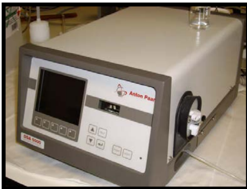
Figura 3.1: Analizador de densidad y velocidad de propagación del sonido Anton Paar DSA-5000.
