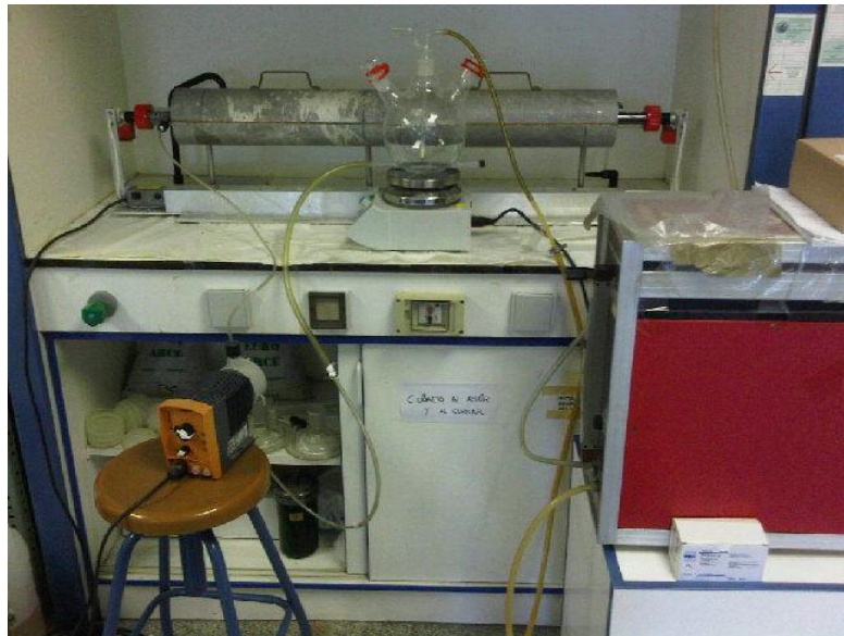
Figura 3.6. Fotorreactor utilizado para el tratamiento combinado ozono/luz UV
