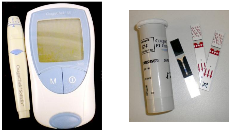
FIGURA 25. EQUIPO DE CHEQUEO DE INR Y TIRAS REACTIVAS MARCA ROCHE MODELO COAGUCHEK
