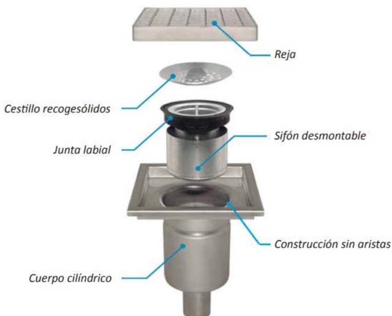
Fig. 5: Despiece específico y por piezas sumidero sifónico tipo. (RASAN, 2016)
