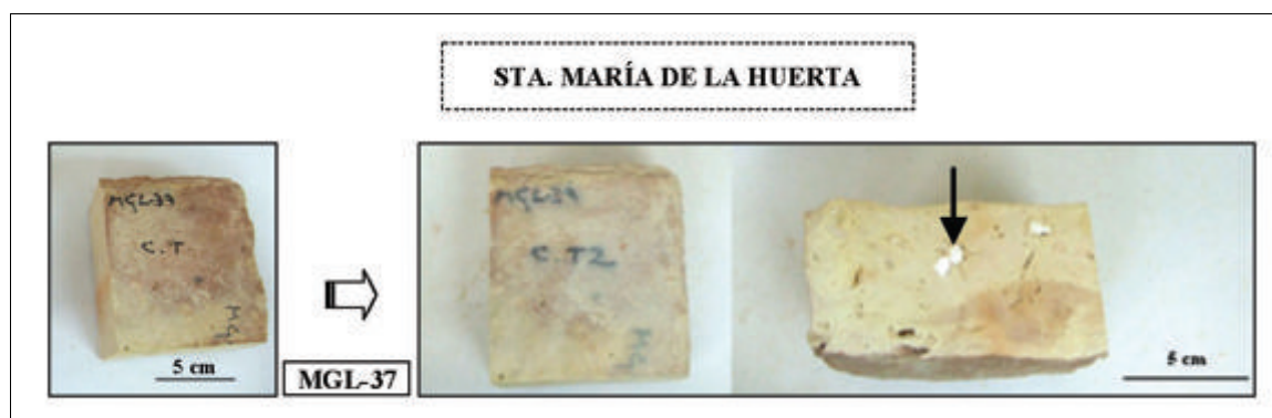
Figura 55. Precipitación de yeso secundario en la porosidad de la muestra MGL-37, observada tras finalizar el ensayo mediante ciclos de choque térmico.
