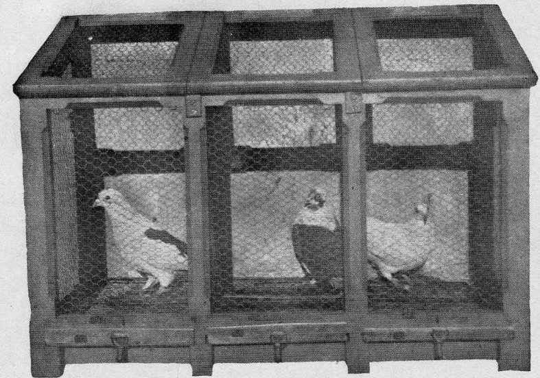
Jaula, para palomas y conejos; adaptándole el cuerpo inferior, ya descrito en el texto, sirve para recoger la orina (separándola de las heces fecales) de los animales en curso de experimentación. Fotografía directa del modelo, mandado construir por L. del Río, existente en el Laboratorio.
