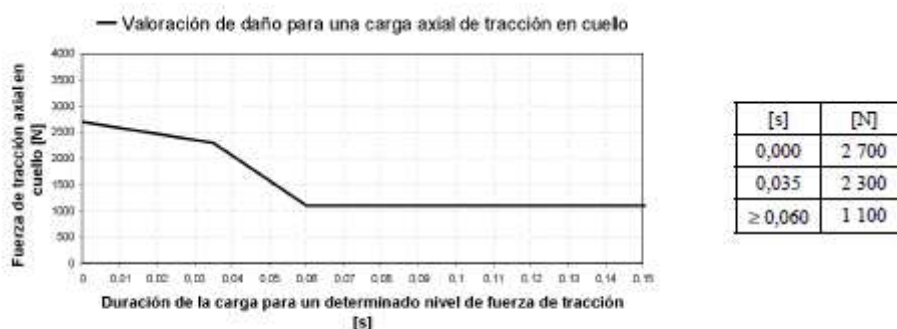
Diagrama 2: Patrón de comportamiento para la tracción del cuello para nivel I
