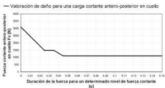
Diagrama 4: Patrón de comportamiento para la cisión del cuello para nivel II
