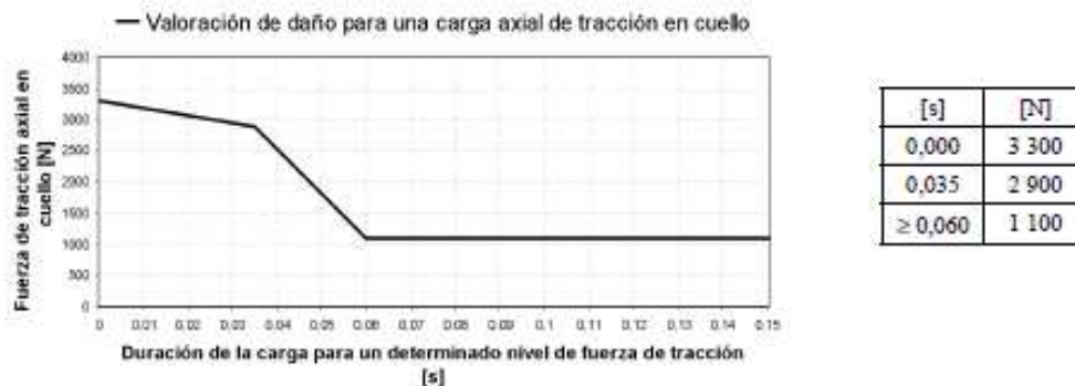
Diagrama 5: Patrón de comportamiento para la tracción del cuello para nivel II
