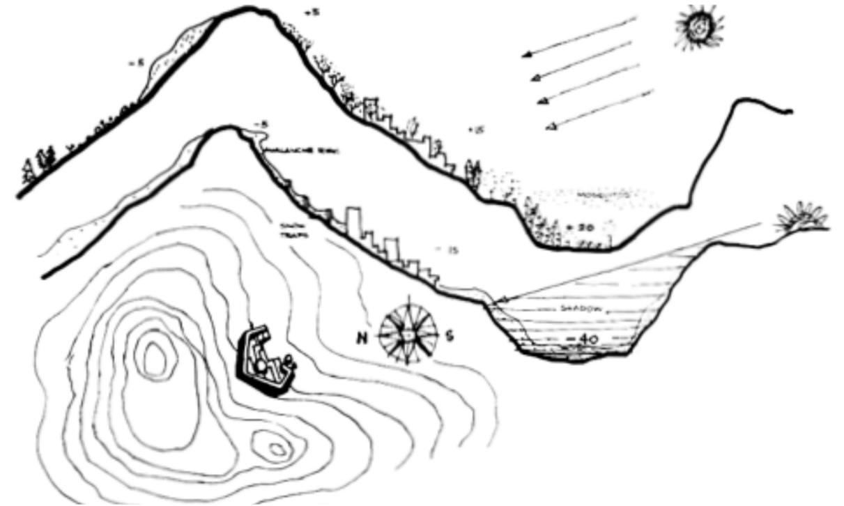
Fig. 69. Ralph Erskine, "Diagrama de emplazamiento sobre la ladera en el ártico en planta". "Secciones de la implantación del proyecto en la ladera sur, indicando la incidencia solar". 1973
