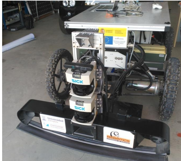
Figura 3.2: Sensores láser frontales del Robucar-TT
