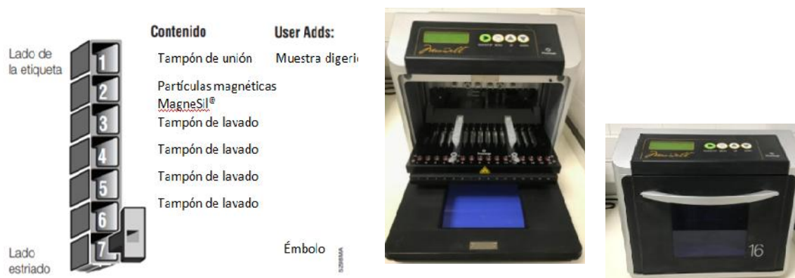
Figura 3.2. Distribución del cartucho de Figura 3.3. Equipo de extracción Maxwell 16 Maxwell 16 Lev Blood DNA Purification Kit. (Promega, Madrid, España).
