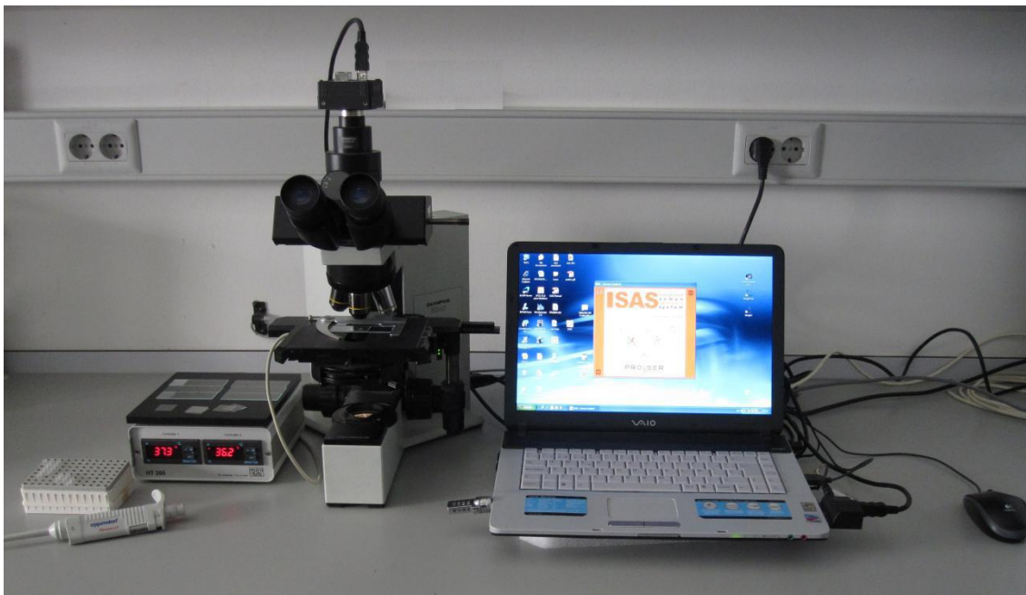
Figura 7. Sistema CASA para el análisis espermático compuesto por un microscopio de contraste de fase conectado a una pletina atemperada, a una cámara de video y a un software de análisis de imágenes por ordenador.
