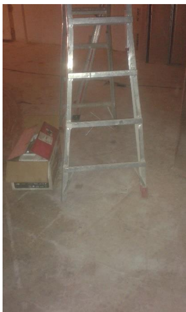
Imagen 7: escalera de mano en mal estado. Taco antideslizante faltante.
