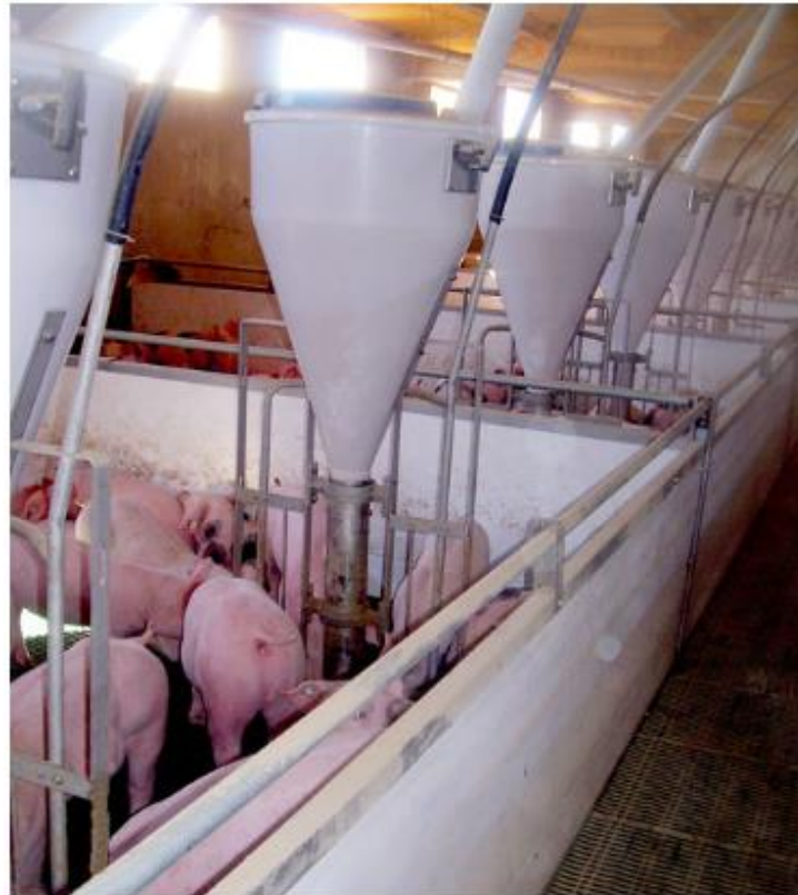
Ilustración 19 Tolva circular alimentación húmeda.
