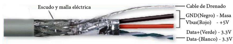
Ilustración 24: Interfaz física USB, cableado[68].
