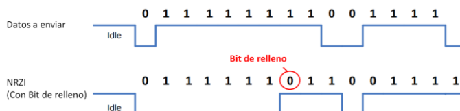
Ilustración 26: USB, NRZI con bit de relleno.
