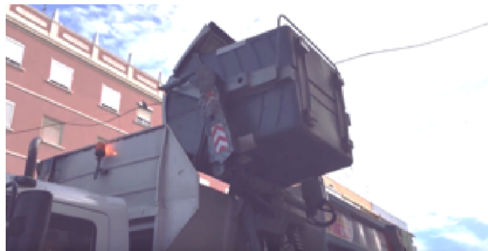
Figura 1.3.8 Volteo del contenedor [7].
