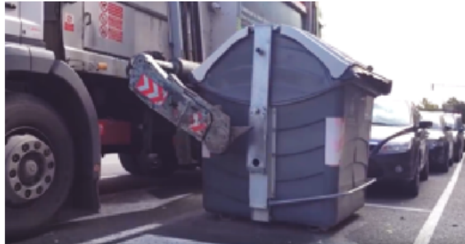
Figura 1.3.3 Ajuste de la anchura de los brazos hidráulicos [7].
