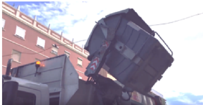
Figura 1.3.7 Volteo del contenedor [7].
