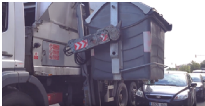
Figura 1.3.5 Elevación del contenedor [7].
