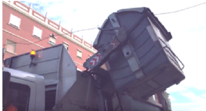
Figura 1.3.6 Inicio de volteo del contenedor [7].
