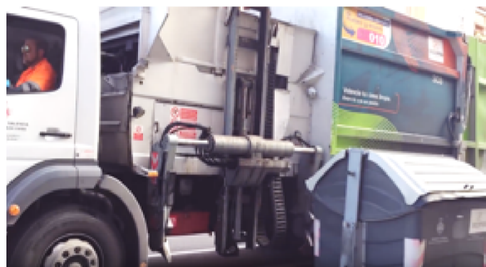
Figura 1.3.14 Alejamiento del contenedor de recogida [7].
