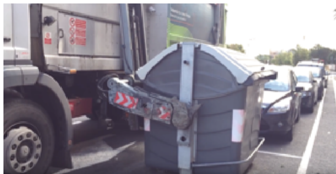
Figura 1.3.11 Apoyo del contenedor en el suelo [7].
