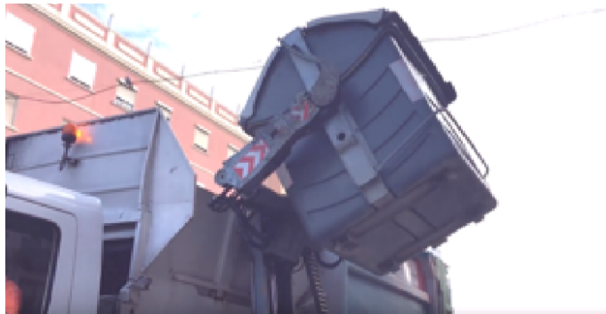
Figura 1.3.10 Vuelta a posición vertical del contenedor [7].
