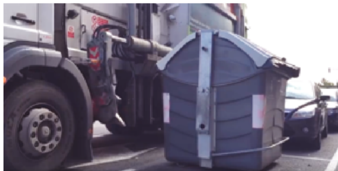
Figura 1.3.2 Despliegue de brazos hidráulicos [7].
