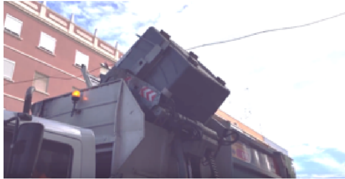
Figura 1.3.9 Descarga del contenedor [7].
