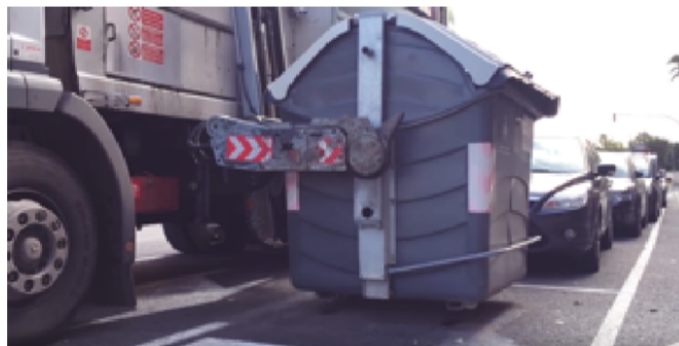
Figura 1.3.4 Comienzo de elevación del contenedor [7].
