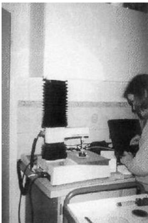
Ilustración 16 Ensayo de Compresión Confinada Realizado por la Universidad de Madrid
