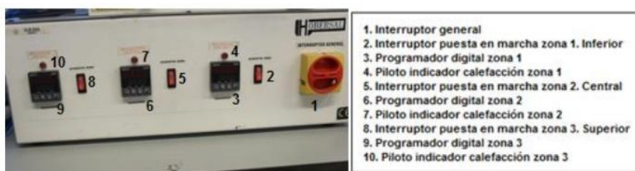
Figura 60. Fotografía del sistema de control de temperatura del horno de la instalación.
