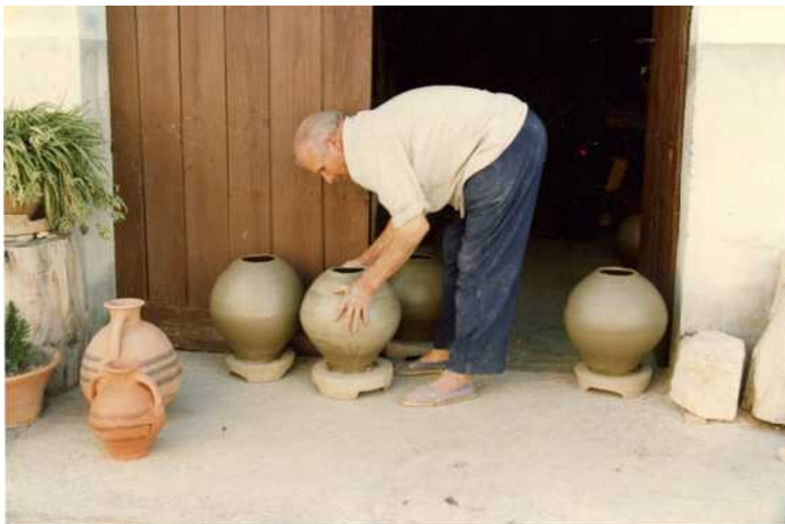
Fig. 30. Pascual Lavarías, sacando a la puerta de su obrador piezas a medio hacer para que se oreen y poder continuar con su factura.
