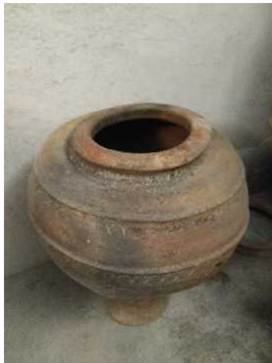
Fig. 34. Tinaja donde se aprecia como el exceso de calor en el horno ha hecho que los labios se hundan hacia el interior por el propio peso de la pieza y las superiores.
