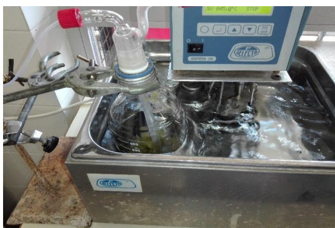
Fig. 5. Frasco de pyrex con borraja cocida + agua en un baño termostaticado a 45 °C
