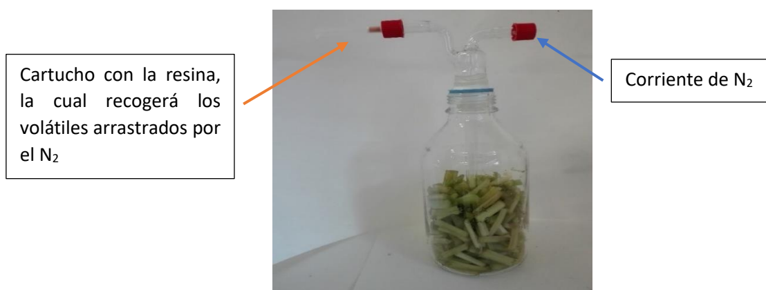
Fig. 4. Frasco de pyrex con la borraja cruda y el tubo por el cual va a pasar la corriente de nitrógeno. El cartucho que va a recoger los volátiles que son arrastrados por la corriente de N_2 está emplazado al final del dispositivo.
