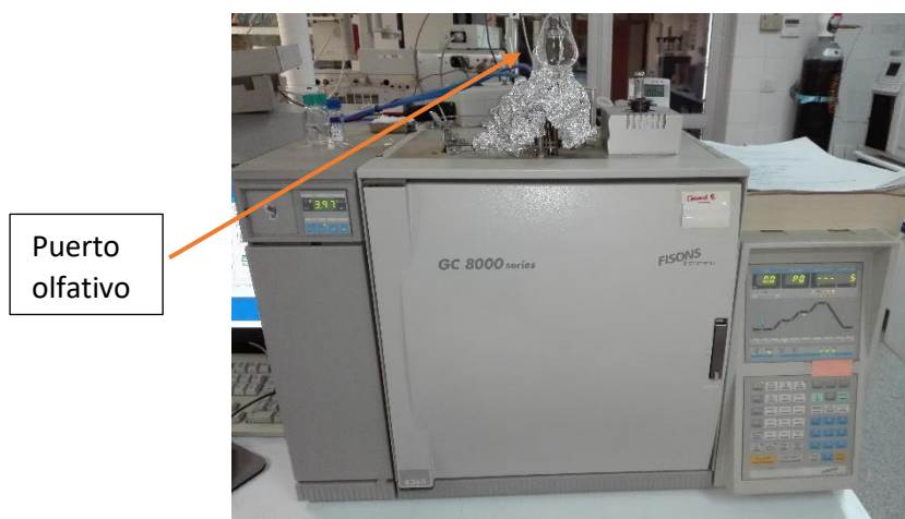
Fig. 7. Cromatógrafo de gases con columna VF-5ms y puerto olfativo.
