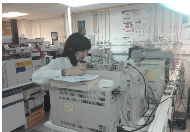
Fig. 6. Sniffer oliendo los componentes de uno de los extractos en cromatógrafo de gases con columna VF5-ms.
