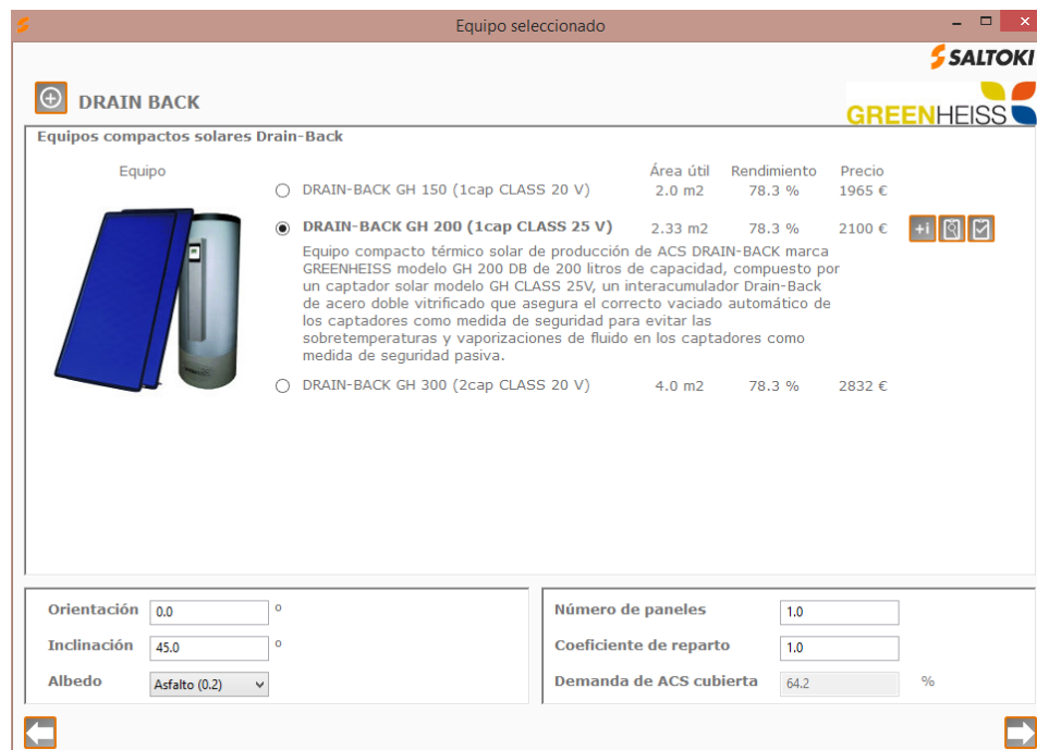
Ilustración 12. Posibles Sistemas de Energía Solar Térmica.
