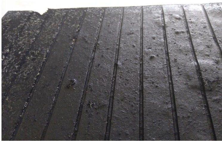
Ilustración 56 Loseta pequeña con desprendimientos en la parte superior izquierda y protuberancias a la derecha.
