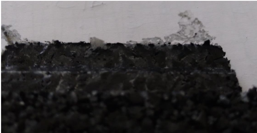
Ilustración 53 Aparición de rebabas en el ensayo nº4.
