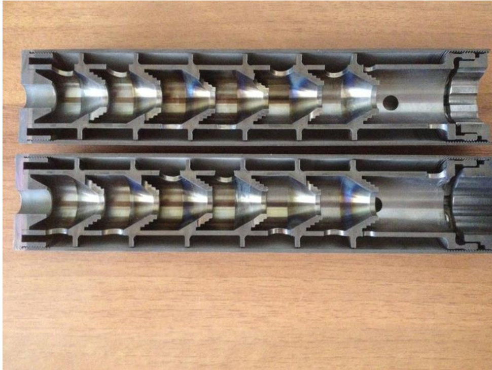
Ilustración 26 Ejemplo de configuración con cámara de expansión cónica empleada en silenciadores de armas.
