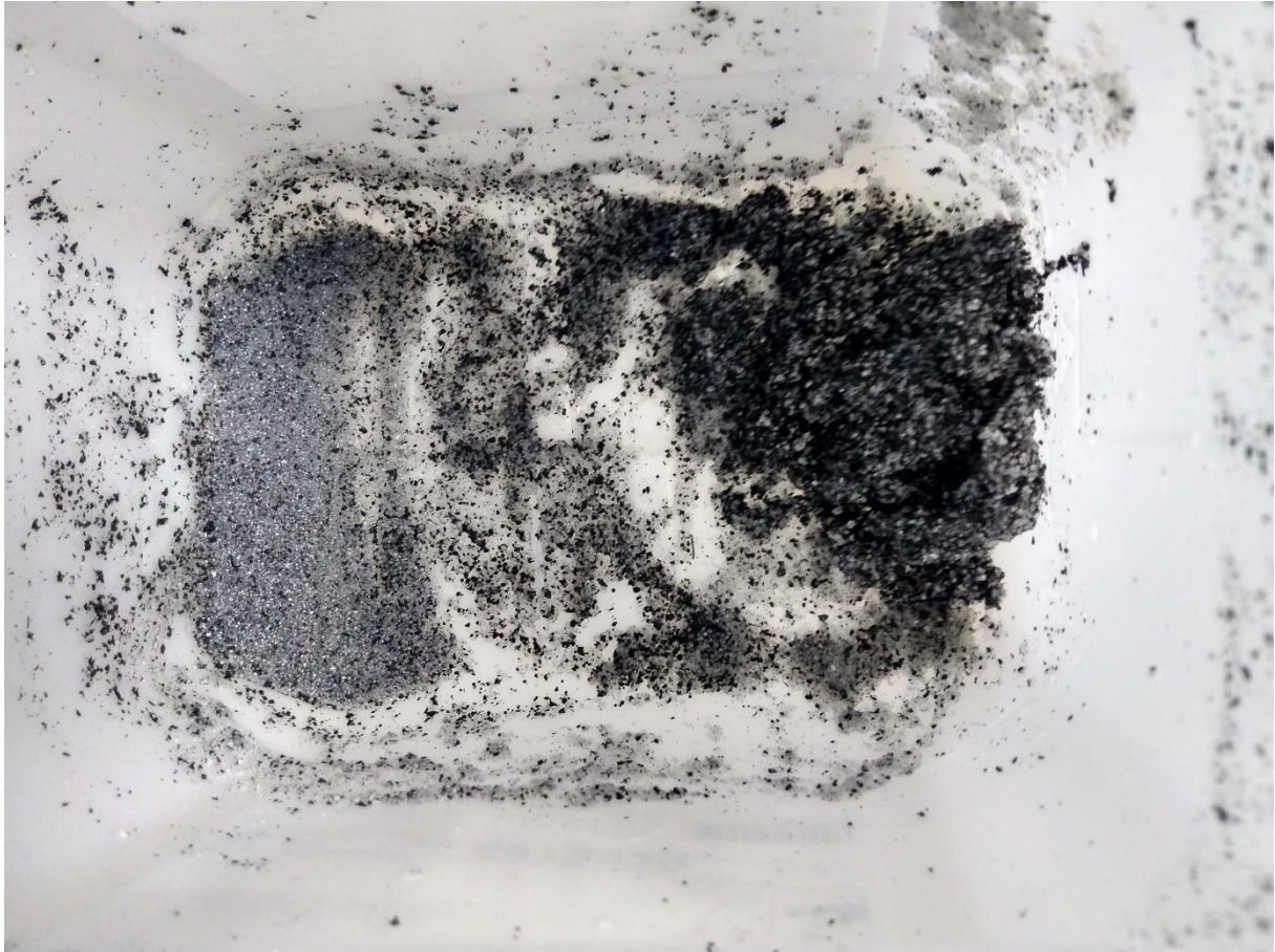
Ilustración 12 Resultado del experimento de separación de la salida del rebabado criogénico mediante densidades.
