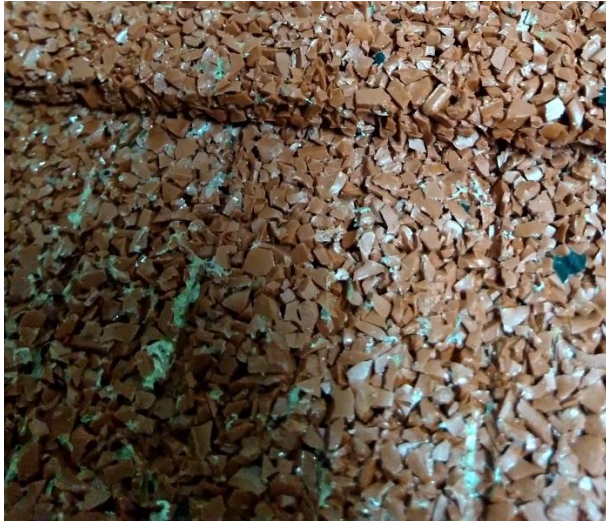
Ilustración 13 Detalle de los granos de un panel a base de silicona triturada.
