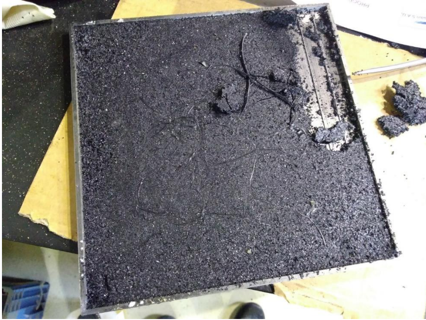
Ilustración 52 Panel pegado a molde a escala sin teflonar (ensayo nº1).
