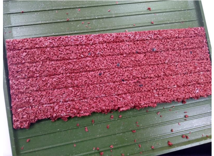
Ilustración 14 Panel a base de silicona triturada con evidentes signos de desprendimientos y fracturas.
