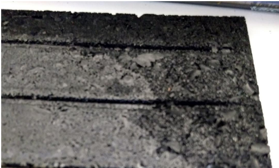
Ilustración 55 Detalle de un panel a escala con la esquina debilitada.
