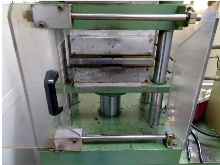
Ilustración 44 Prensa de laboratorio con el molde a escala aún sin teflonar (ensayo nº1).
