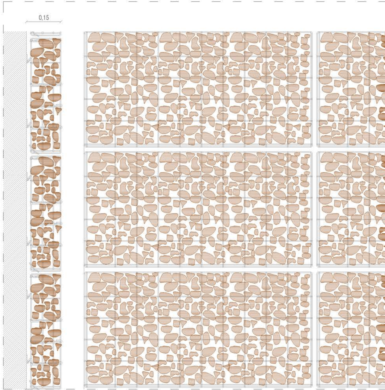
P 5 : ACABADO DE PANELES DE GAVIONES INTERIOR Y EXTERIOR
