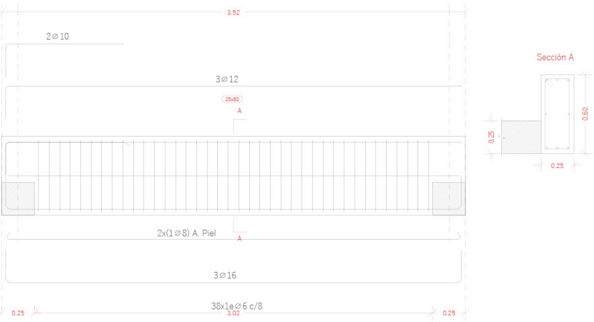
VIGA 2 M3 - Zuncho en muro de piedra
