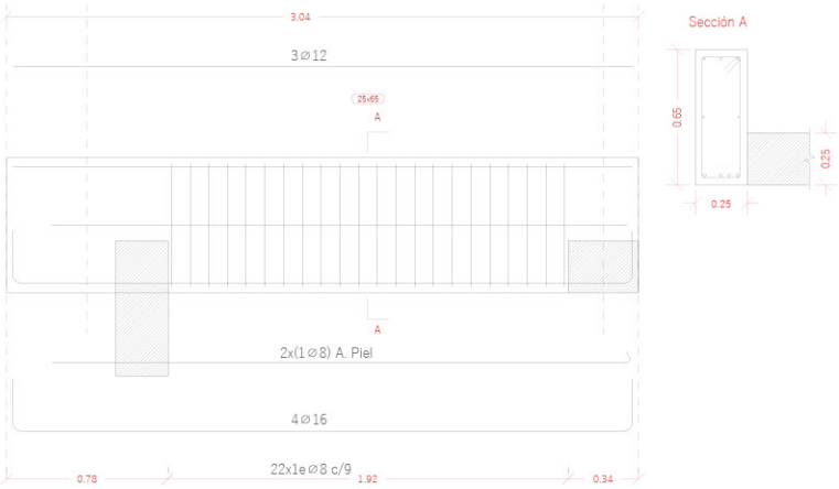
VIGA 2 M13 - Zuncho en muro de piedra
