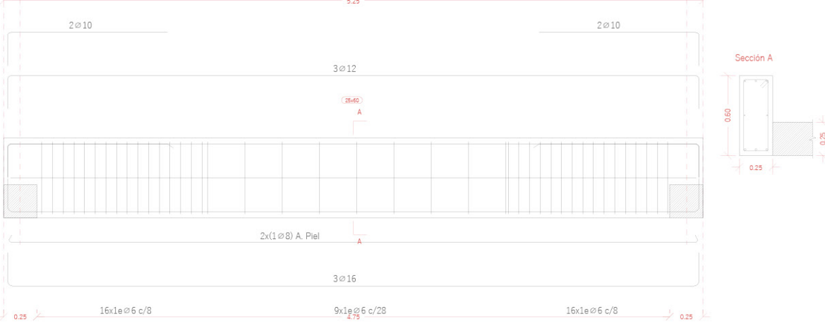
VIGAS 5, 7 y 13 M9 - M7 | M13 - M10 | M13 - M10
