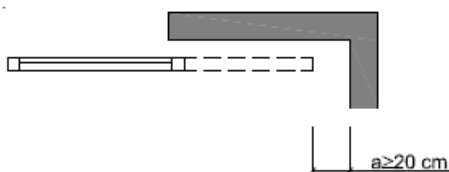
Figura 2.1 Holgura para evitar atrapamientos
