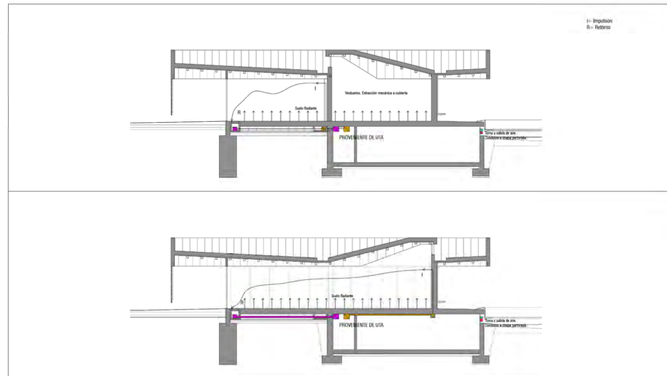
ESQUEMAS IMPULSIÓN/RETORNO RENOVACIÓN AIRE EDIFICIO PÚBLICO. Climatización mediante suelo radiante
