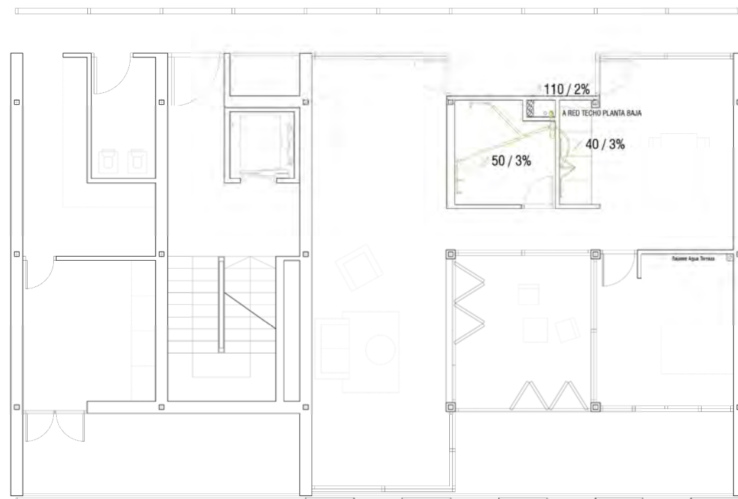
ZOOM SANEAMIENTO VIVIENDA
