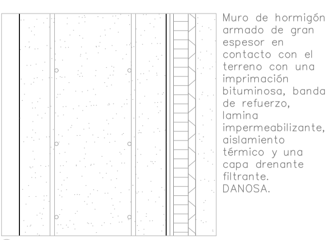
17) MURO FLXORRESISTENTE CON IMPERMEAB. DANOSA
