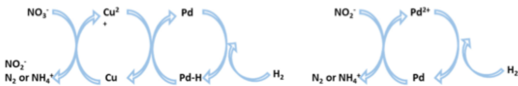
Figura 2. Mecanismos de reacción de la reducción catalítica de nitratos.
