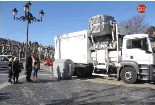
Figura 3.26. Proceso de recogida de un contenedor de carga lateral. [21]
