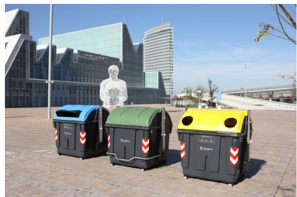
Figura 3.1. Contenedor de carga lateral de 3200 litros de capacidad fabricado con polietileno de alta densidad mediante el proceso de inyección de plástico [2].
