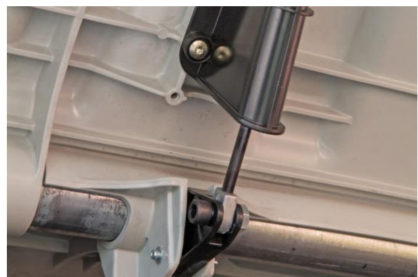
Figura 3.25. Mecanismo amortiguador en tapa de usuario [20]
