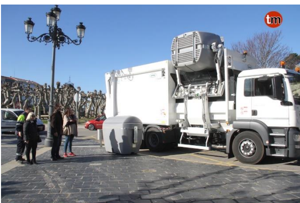
Figura 3.26. Proceso de recogida de contenedor de carga lateral [21]
