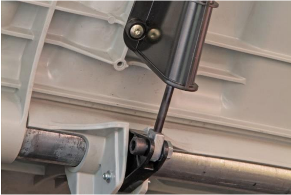
Figura 3.25. Mecanismo amortiguador en tapa de usuario [20]
