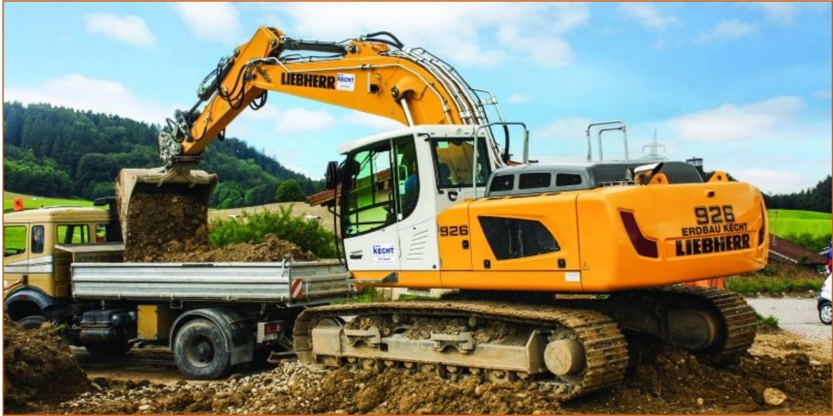
Imagen 5. Excavadora con cadenas cargando tierra en un camión
