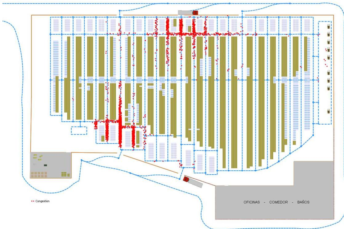
Ilustración 61. Puntos en los que se produjeron cruces de carretillas (utilizado para el cálculo de congestión).
