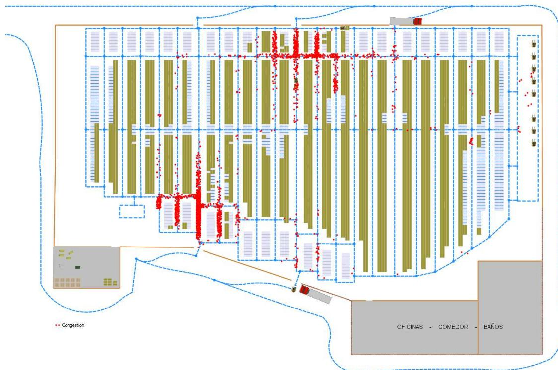
Ilustración 118. Puntos en los que se produjeron cruces de carretillas (utilizado para el cálculo de congestión).
