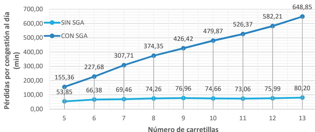
Ilustración 64. Relación entre el tiempo diario perdido por congestión (minutos) y el número de carretillas utilizadas por el almacén, con y sin SGA. Se utiliza el cambio de horario propuesto.
