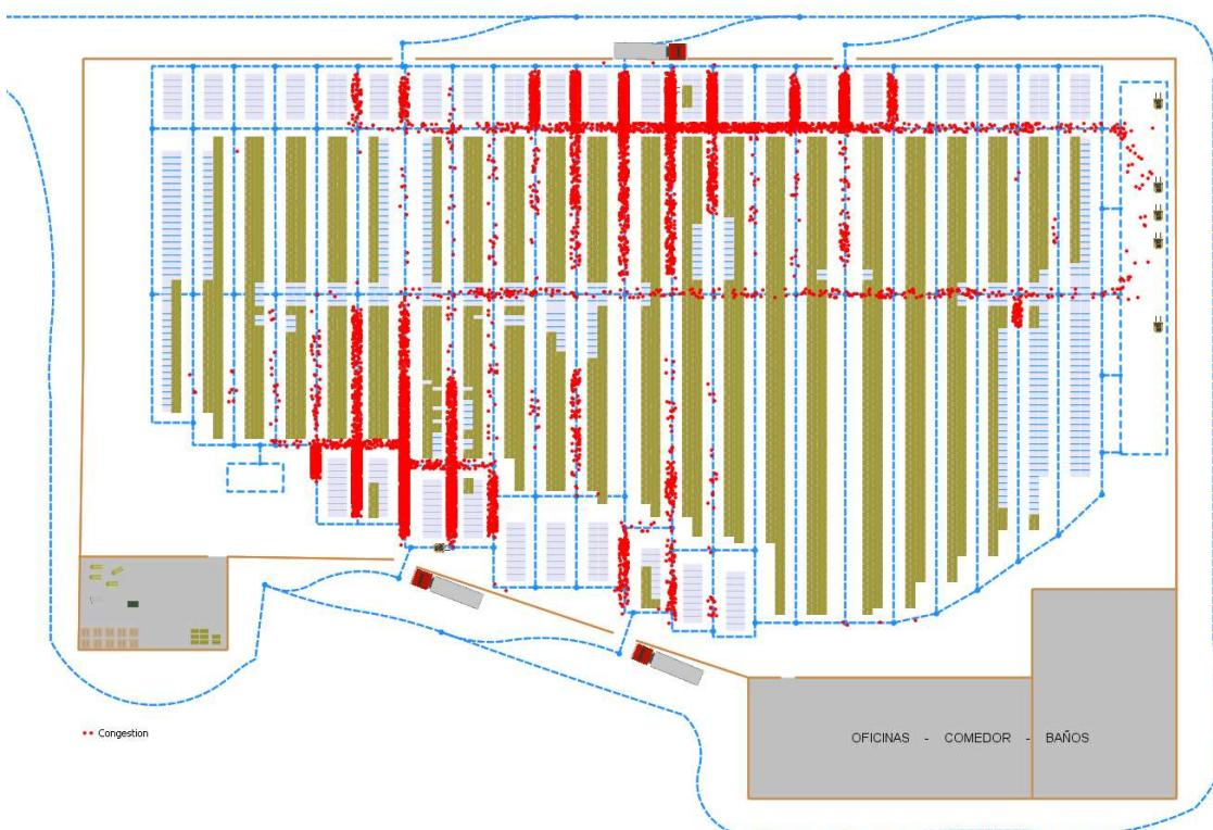
Ilustración 75. Puntos en los que se produjeron cruces de carretillas (utilizado para el cálculo de congestión).
