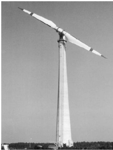
Figura 2.7: Aerogenerador eje horizontal bipala [1]
