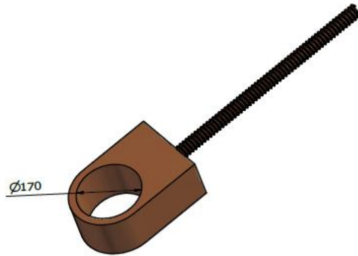
Figura 4.9 Componente del brazo extensible (cotas en mm)
