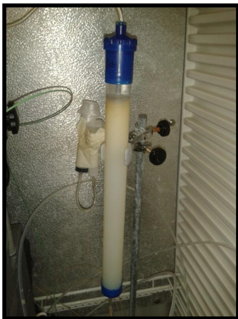
Figura 35: Mutante D100N cargado en la columna de DEAE-celulosa, no presenta la coloración característica de las holoflavodoxinas debida a su unión al cofactor FMN.
