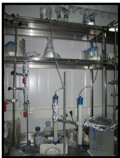
Figura 18: Columnas de DEAE-celulosa (ya equilibradas) cargando el sobrenadante obtenido de la precipitación del extracto crudo con sulfato de amonio. Sistema montado en la cámara fría para mantener la temperatura de 4°C.
